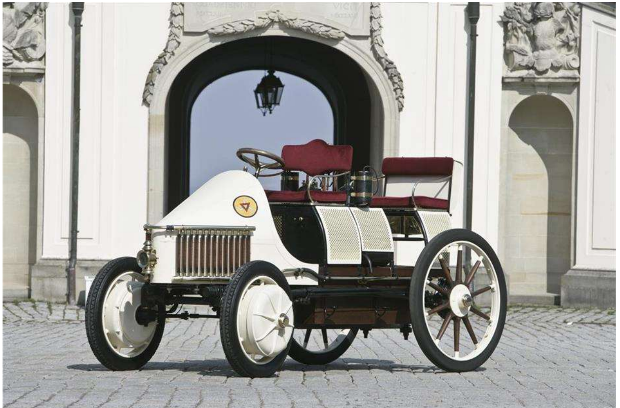
Replica del Lohner-Porsche, que funcionaba mediante dos motores eléctricos ubicados en los bujes de sus ruedas delanteras.
