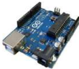
Arduino UNO con microcontrolador en formato DIP
