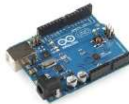
Arduino UNO con microcontrolador en formato SMD
