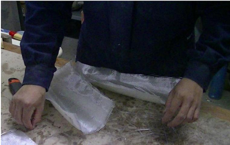
**Imagen 31** - Fabricación de Cono en Fibra de Vidrio
