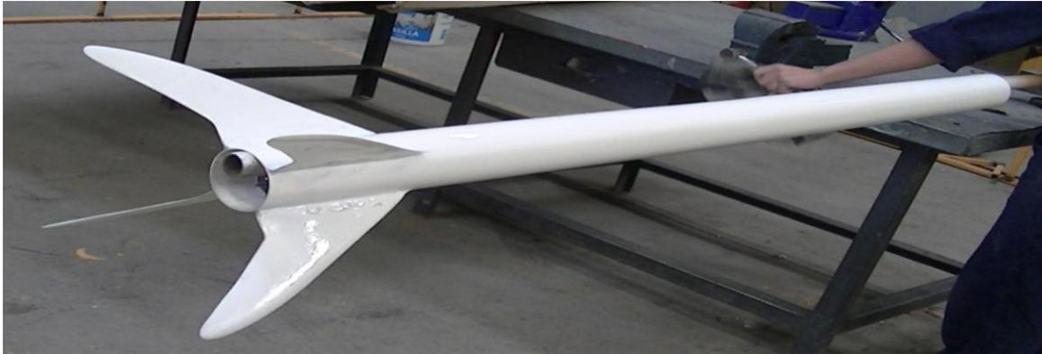
**Imagen 28** - Imprimación de Fuselaje y Aletas (preparación para el pintado)
