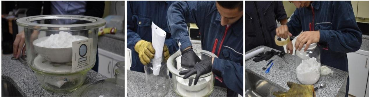
**Imagen 41** – Proceso de cocción para eliminar la humedad del Nitrato de Potasio en el laboratorio de la Universidad Nacional Tecnológica.
