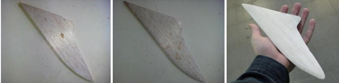
**Imagen 23** - Proceso de moldeado de aletas estabilizadoras. (Visualizar Anexo III – Plano 7 para plano de aleta).
