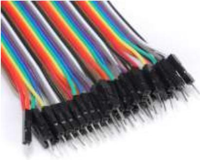
Utilizados para conectar desde el arduino a los LEDs RGB y las matrices LED MAX7219 8X8.
