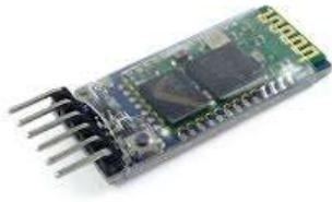
Concebido para la instalación de una conexión serial inalámbrica transparente.
